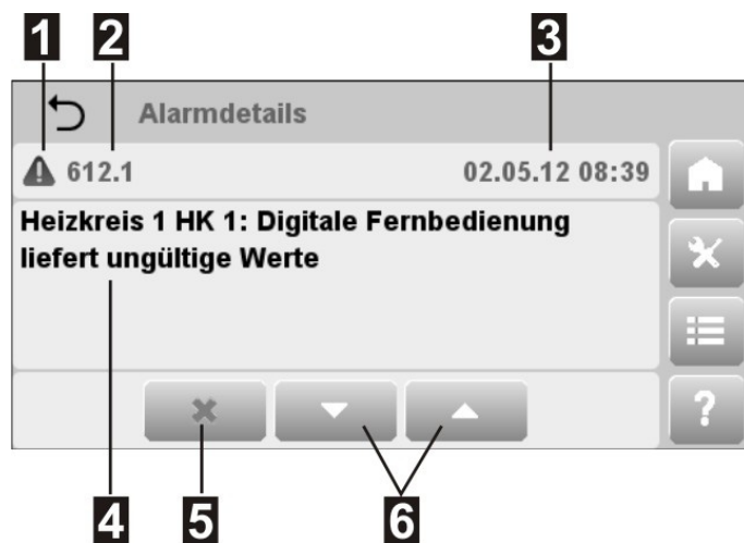
Abb.4-12: Detailmenü - Alarme - Detailmaske
